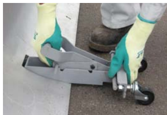
④ 解体①～③の順序で、同様にキャリー胴体部と脚部とを切り離す
